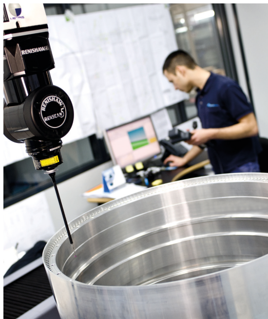
REVO skenuje široké vrtání na letecké komponentě
